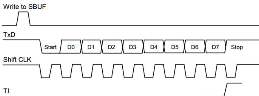
Figure 13-5 模式 1 数据发送时序框图
