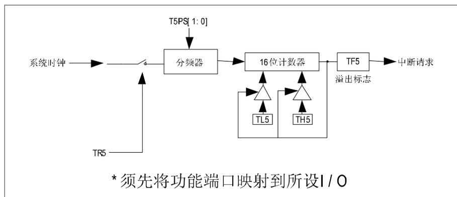
Figure 9-8 TIMER5 方式 0 功能框图
