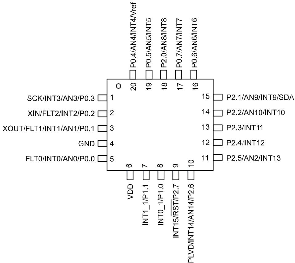
Figure 1-3 QFN20 引脚配置图
