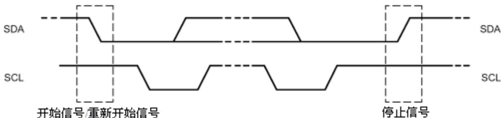
Figure 15-4 开始、重新开始、停止信号
