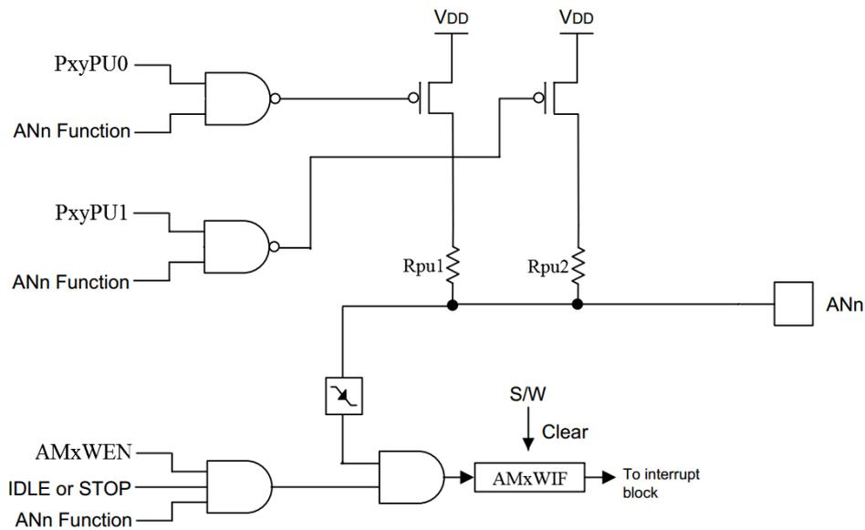
Figure 16-2 ADC 省电唤醒功能框图
