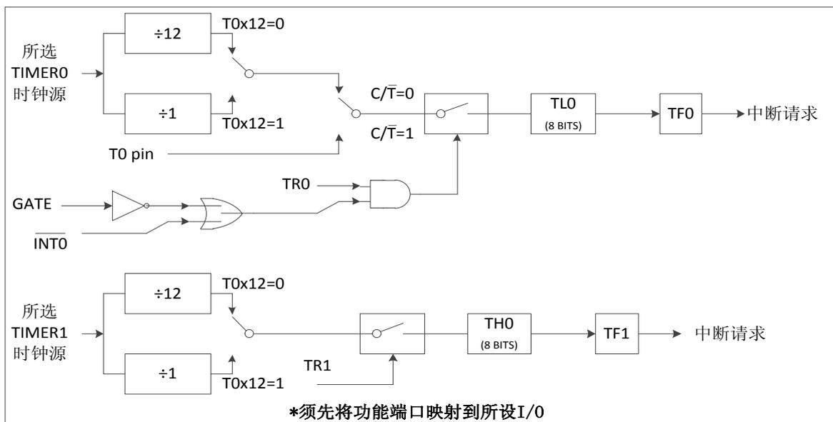
Figure 9-4 TIMER0 方式 3 功能框图
