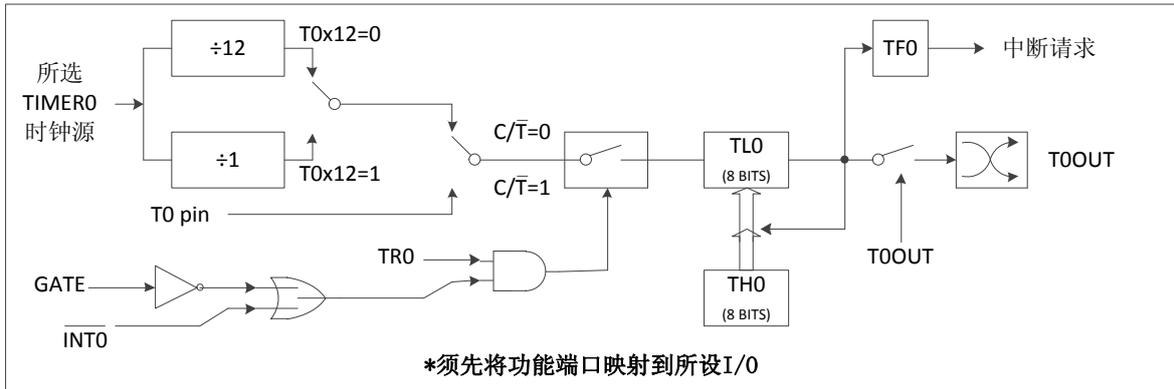
Figure 9-3 TIMER0 方式 2 功能框图
