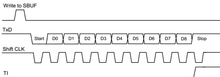
Figure 13-8 模式 2 数据发送时序框图
