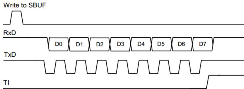
Figure 13-2 模式 0 数据发送时序框图
