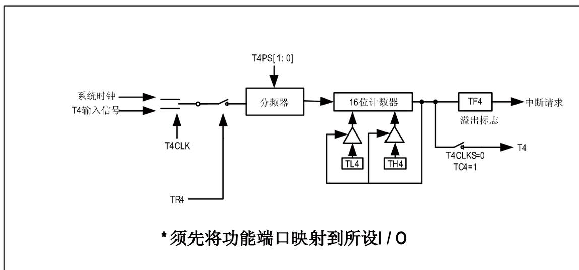
Figure 9-6 TIMER4 方式 0 功能框图
