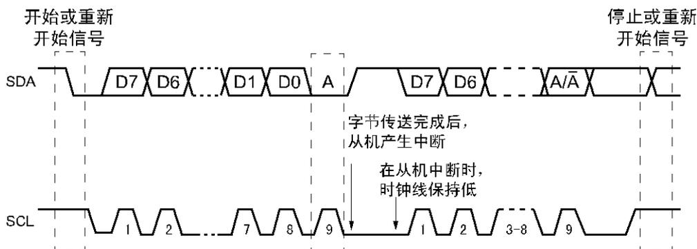
Figure 15-6 IIC 总线的数据传输格式
