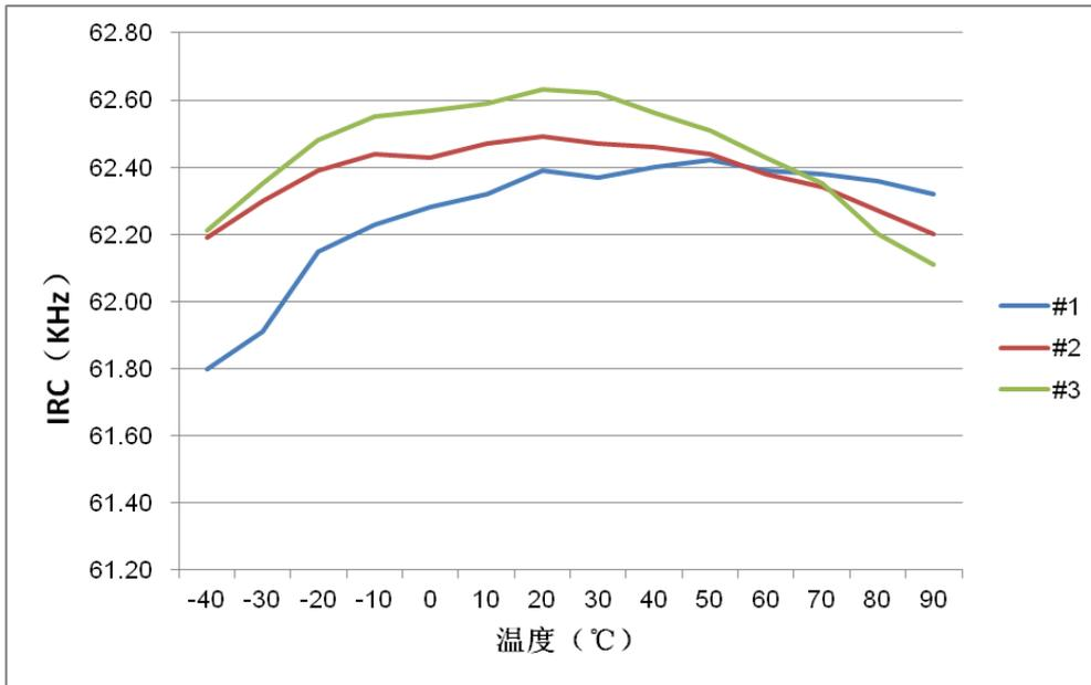
Figure 21-5 内部高频 RC32M/512-温度特性曲线图
