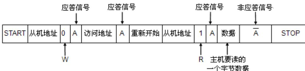
Figure 15-8 主机向从机读写数据 1 个字节数据
