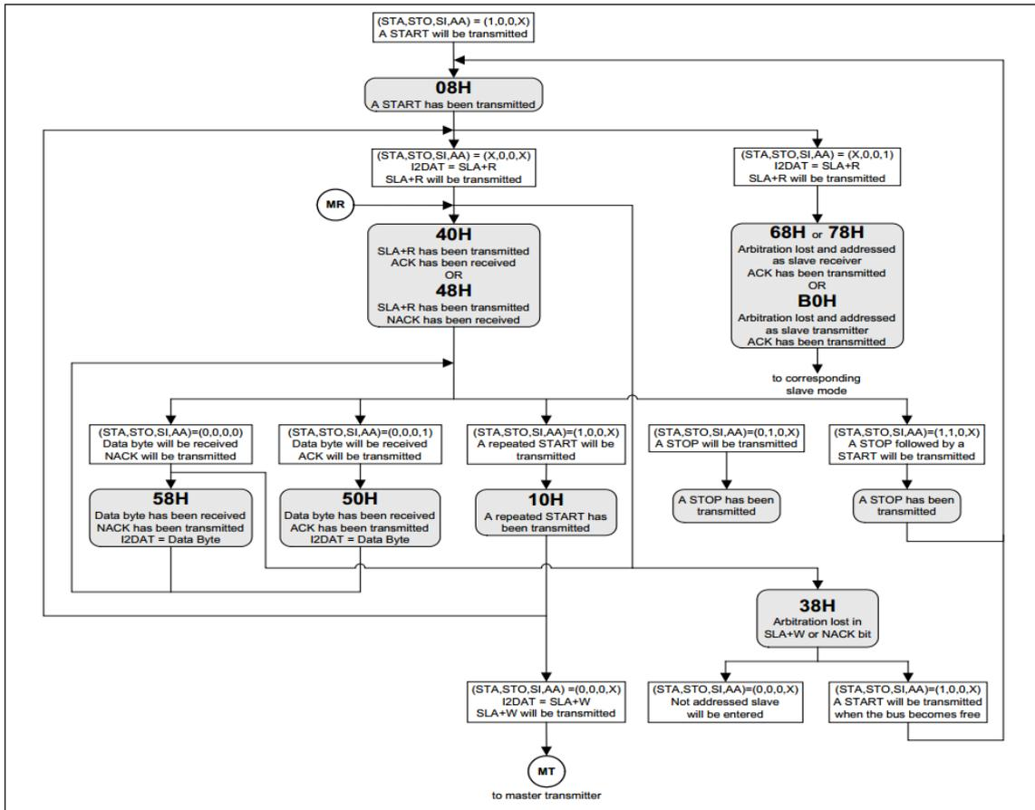
Figure 15-10 主机接收模式流程与状态
