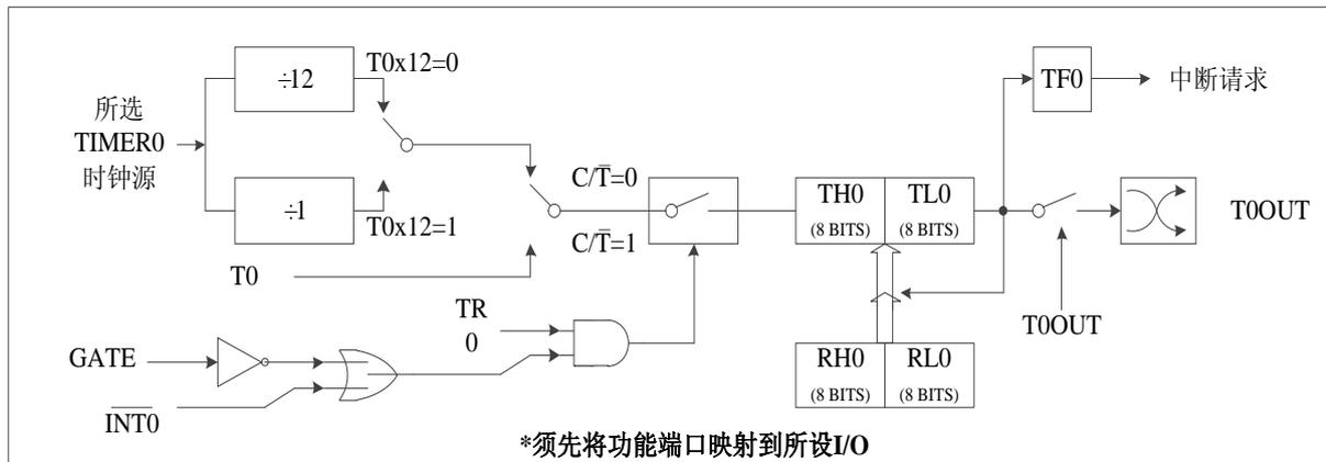
Figure 9-1 TIMER0 方式 0 功能框图
