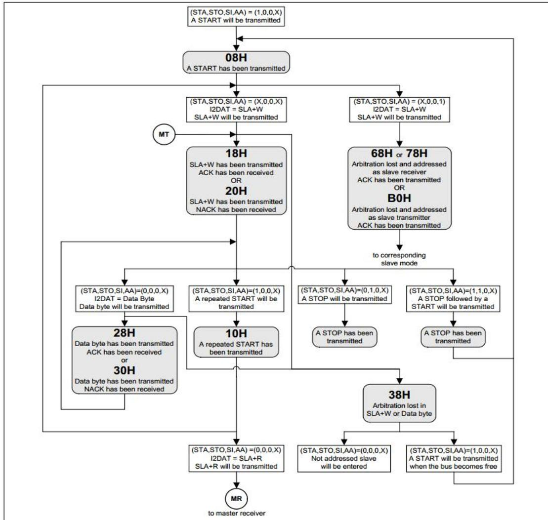
Figure 15-9 主机发送模式流程与状态
