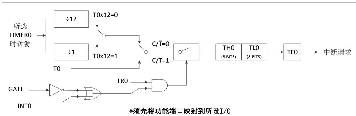
Figure 9-2 TIMER0 方式 1 功能框图
