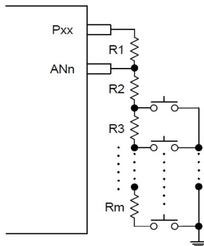
Figure 16-3 ADC 按键输入串联电阻应用参考图
