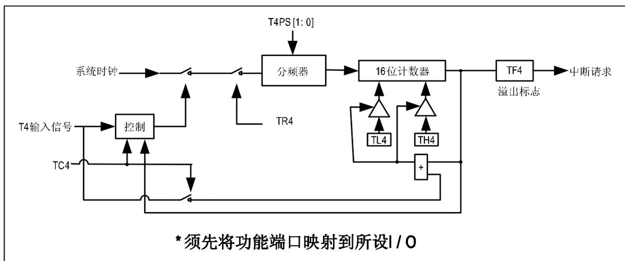
Figure 9-7 TIMER4 方式 2/3 功能框图
