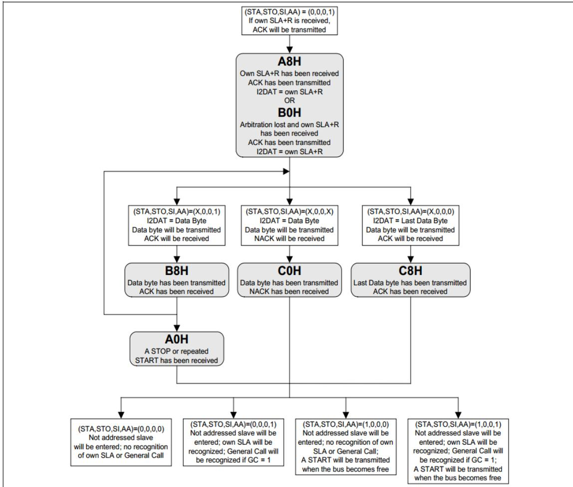
Figure 15-11 从机发送模式流程与状态
